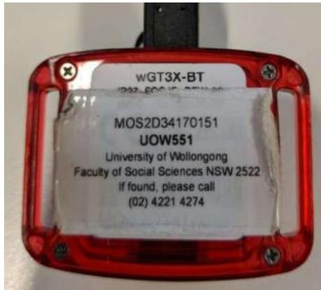
Figura 2: Acelerômetro GT3X+ com um exemplo de etiqueta contendo o número de série e o centro de pesquisa pertencente.
